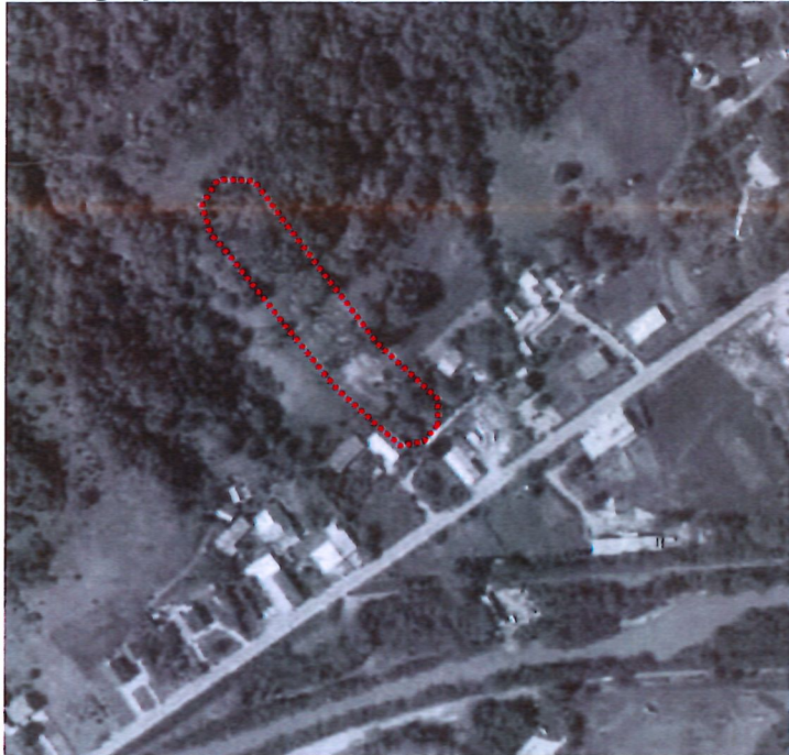
Figure 3: photographie IGN de 1982. Des traces assez nettes d'une coulée de boue sont identifiables à l'emplacement du phénomène « de 1984 ». Il semble qu'il y ait eu confusion dans les dates et que cette coulée de boue date de janvier 1982 (la fiche-événement sera corrigée ainsi que les données de la BDRTM). Le versant présente déjà un aspect boisé, mais moins dense qu'en 2015 (cf. figure suivante). La coulée est partie dans le taillis entre 780 et 800m d'altitude, a traversé de manière désorganisée les terrains agricoles en cours d'enfrichement, puis s'est diffusée dans la parcelle AD 485. L'ampleur et l'intensité du phénomène semblent limitées d'après la photographie. Les photographies IGN de 1983 et de 1985 ne font plus apparaître le phénomène. Si la coulée de boue s'était produite en 1984, elle aurait encore été partiellement visible en 1985.
