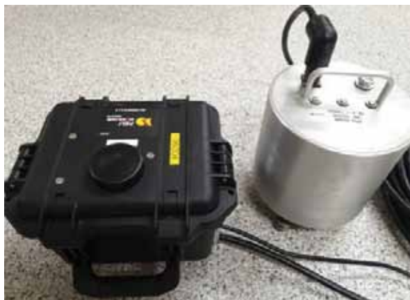
1 & 2. Photos d'un boîtier numériseur comportant un système d'acquisition + un modem de télécommunication (boîtier noir), ainsi qu'un capteur sismique vélocimétrique (cylindre métallique), avec son câble.
