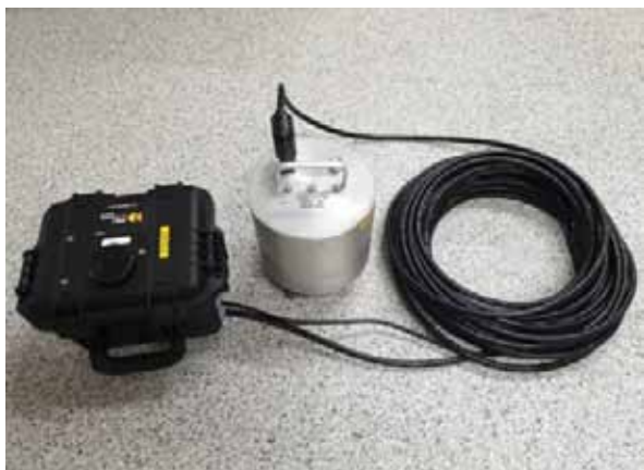
1 & 2. Photos d'un boîtier numériseur comportant un système d'acquisition + un modem de télécommunication (boîtier noir), ainsi qu'un capteur sismique vélocimétrique (cylindre métallique), avec son câble.
