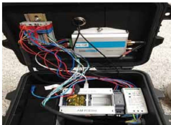
4. Zoom sur l'intérieur du boîtier numériseur
