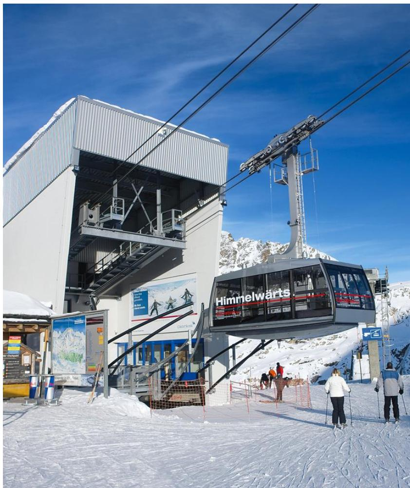
Figure 14 : Téléphérique à va-et-vient
