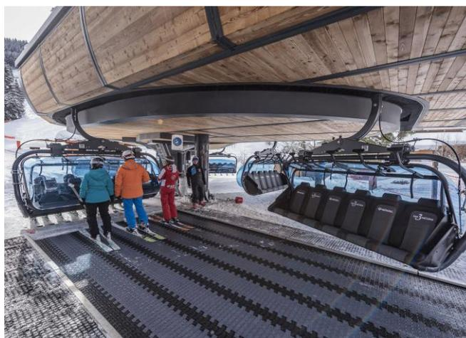
**Figure 5 : Télésiège débrayable en gare avec tapis d'embarquement**
